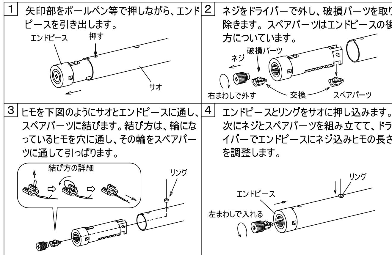
2. 製品及び天井の保護のため、もしも操作棒に大きな荷重がかかると、先端のフックが破損して外れる仕組になっています。
